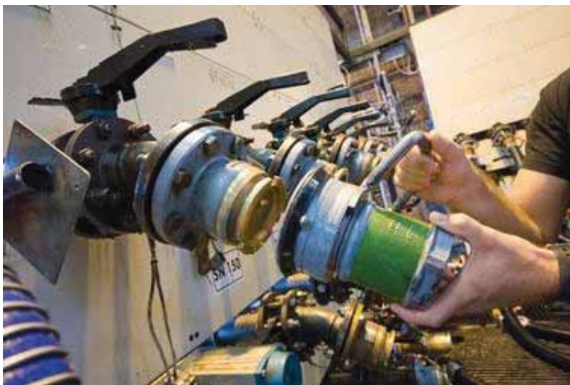
Az olajak keverésére használt ún. panel, a - régebben a Forma1-ben is rendszeresített – automatikus elzárású csatlakozókkal
